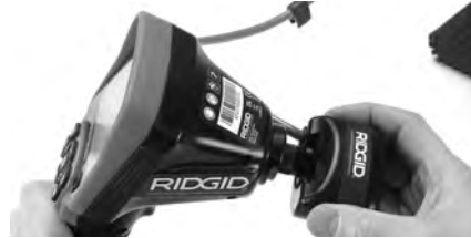
Figuur 18 – Cameraverbindingsstekker Geïnstalleerd
