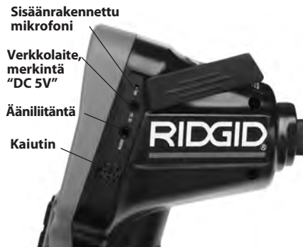
Kuva 3 – Oikean puolen portin suojus
