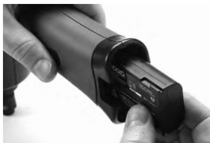
Figura 6 – Extracción e instalación de la batería
