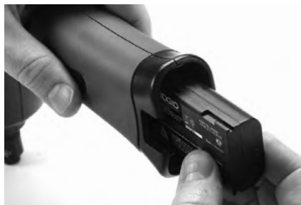
Figura 6 - Rimozione e installazione della batteria
