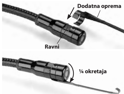
Slika 8 – Ugrađivanje dodatnog pribora
